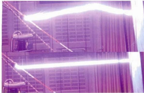
«Abb. 1 Das Teramobile in der Hochspannungshalle. Auf der rechten Seite sind Teile des Hochspannungsgenerators und der Elektroden zu sehen.
