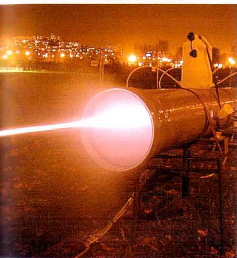
**Figure 7.** Démonstration de la télédétection de simulants d'aérosols biologiques avec le lidar TéraMobile. Le faisceau laser TéraMobile illumine une chambre à nuages où un brouillard est produit.
