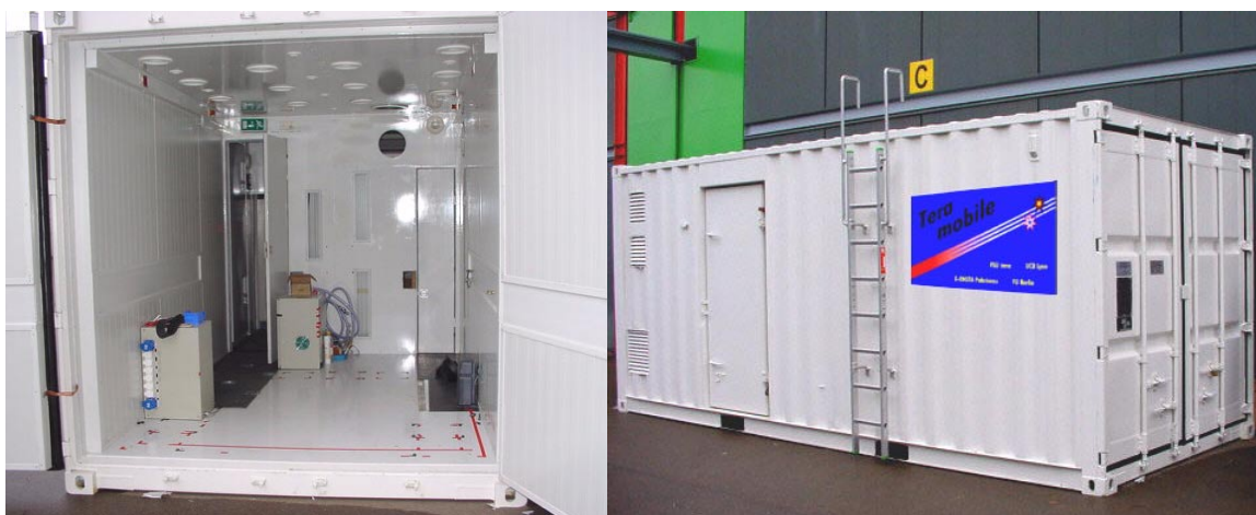
Bild 1-6. Der Teramobile-Container. Links: Innenansicht des Laserraums vor dem Einbau des Lasertisches. Im Hintergrund Trennwand zum Kontrollraum mit den zwei Durchgangstüren (schmalere rechte geschlossen). Rechts: der fertiggestellte Labor-Container.
