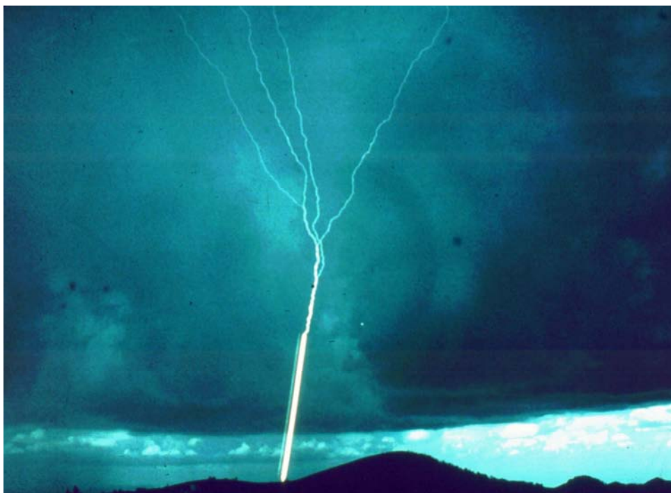
Fig. 5.10 – Foudre déclenchée par une fusée qui déroule une bobine de fil attachée à sa base. La partie de décharge rectiligne correspond à la partie guidée par le fil. ©Lamgmuir Lab, New Mexico Tech
